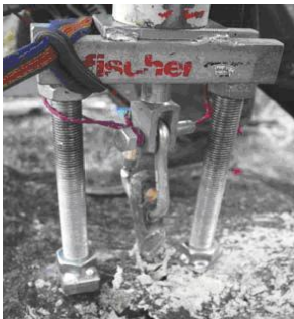
Slika 16: izvleek sidra v njegovi osi s hidravliko
