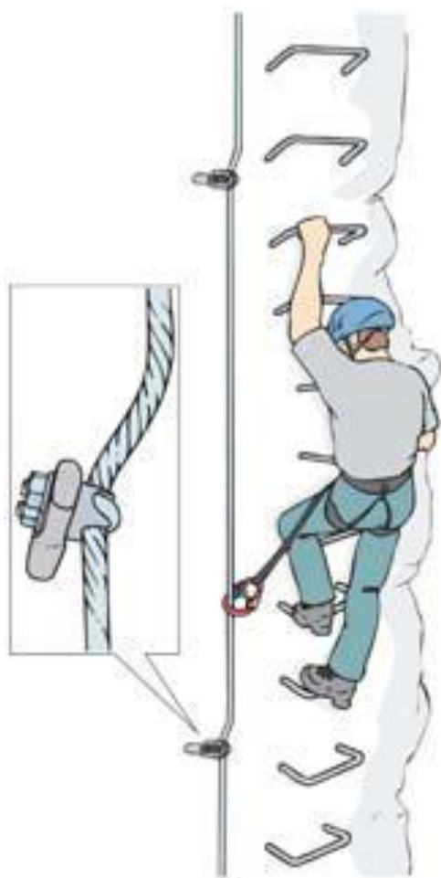
Slika 5: Gradnja z direktnim vpetjem in nenapeto jekleno vrvjo
