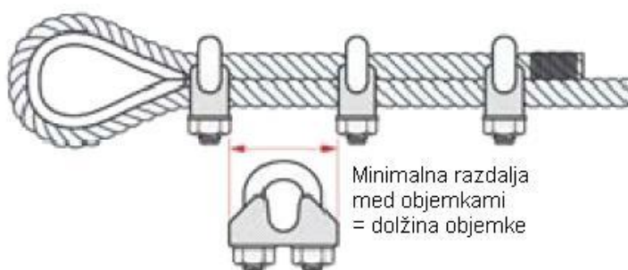
Slika 20: Način kako fiksirati konec jeklene vrvi z objemkami. Notranji vložek je na koncu neobremenjene jeklene vrvi.
