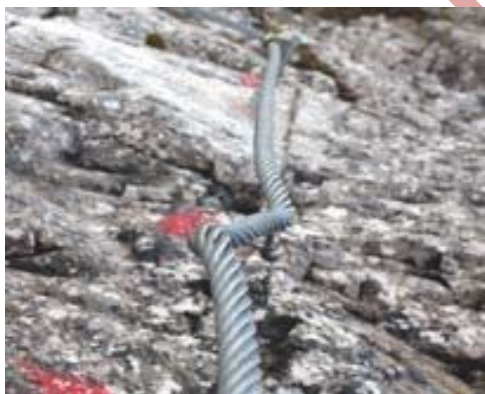
Slika 33: Poškodbe jeklene vrvi – krotovičenje, nastalo pri napačnem odvijanju
