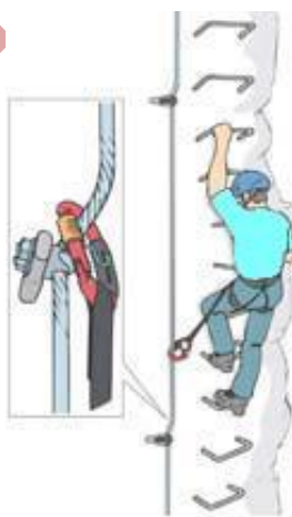
Slika 9: Vponka na stisnjenih sidrih z nenapeto jekleno vrvjo
