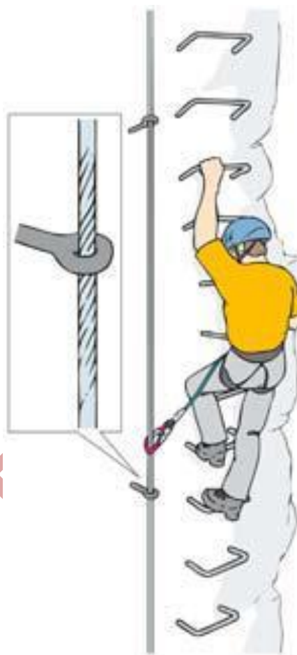
Slika 6: Očesni način gradnje z močno prednapeto jekleno vrvjo
